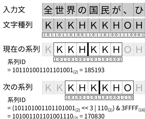
図 5 文字種系列の ID を計算する例。窓幅 W = 3 としている。文字種の下に数字は、各文字種に対応したコード値を表す。Cd(H) = 001 (2) はひらがな、Cd(K) = 101 (2) は漢字、Cd(O) = 110 (2) はその他の文字種に対応している。次の系列 ID は、現在の系列 ID に対するビット演算によって求まる。
